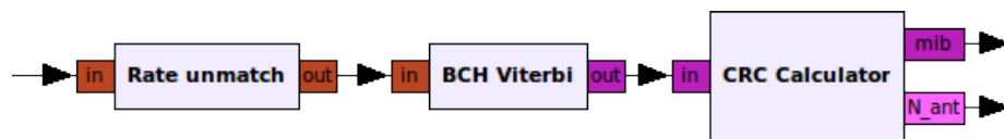
Abbildung 3.11.: Innere Struktur des Blocks BCH Decoding
