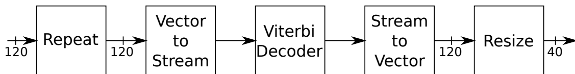
Abbildung 3.12.: Schematische Darstellung des Blocks BCH Viterbi
